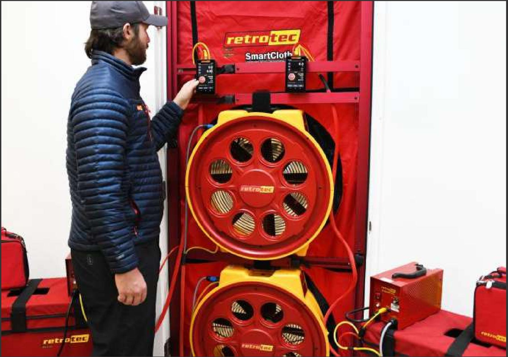
Cualquier ambiente protegido con agentes limpios o CO2, de acuerdo a NFPA 2001 y NFPA 12, debe tener un grado de estanqueidad para que la concentración de la descarga se mantenga por un tiempo determinado. Estos ambientes protegidos deben inspeccionarse detenidamente al menos 1 vez por año para identificar y corregir cualquier espacio, abertura, pase o cualquier área abierta que pueda afectar el nivel de estanqueidad por fugas indeseadas del agente limpio o CO2.
